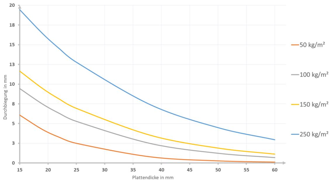
Durchschnittliche Durchbiegung in Abhängigkeit der Plattendicke und aufgebrachtener Prüflast; Spannweite 800 mm
