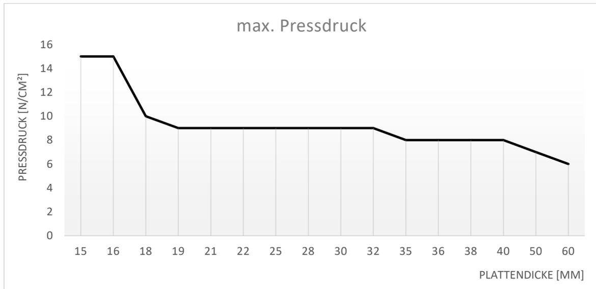
Generell sollte der Pressdruck beim Verarbeiten von Lisocore® reduziert werden, um eine Beschädigung der Platte zu vermeiden!
