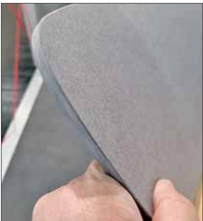
Nachhaltigkeit spielte auch bei Owi eine große Rolle. Oben zu sehen sind Kunststoffstuhlschalen aus recyceltem Propylen, unten zu sehen ist ein Formteil mit 2 mm starker Deckschicht, hergestellt aus alten Jeanshosen.
